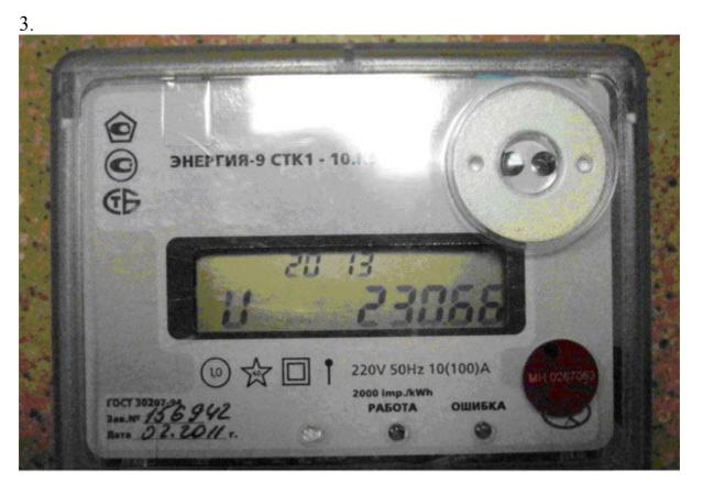
Индикация напряжения в питающей электросети (напряжение составляет 230.66 Вольт)
