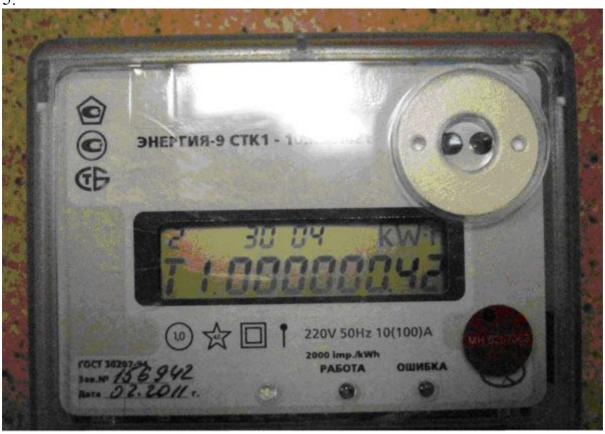
Индикация количества электроэнергии учтенной по тарифу 1 (при использовании одноставочного тарифа значение параметра тарифа 1 соответствует значению суммы, отображаемой символом Е. При программировании электросчетчика на оплату по дифференцированному тарифу по зонам суток значение Т1 - соответствует дневному тарифу, Т2 – соответствует ночному тарифу, а Е – сумма тарифов Т1 и Т2).
