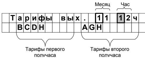
Переключение маркера между зонами индикации «**Месяц**» и «**Час**» производится кнопкой маркер. Выбор номера месяца и часа производится кнопкой «Ввод».
