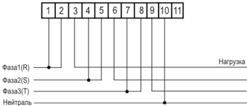
Примечание – Перемычки между контактами 1-2, 4-5, 7-8 расположены на колодке.
