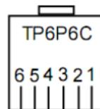
б) - обозначение контактов ответной части разъема "19" TP6P6C
