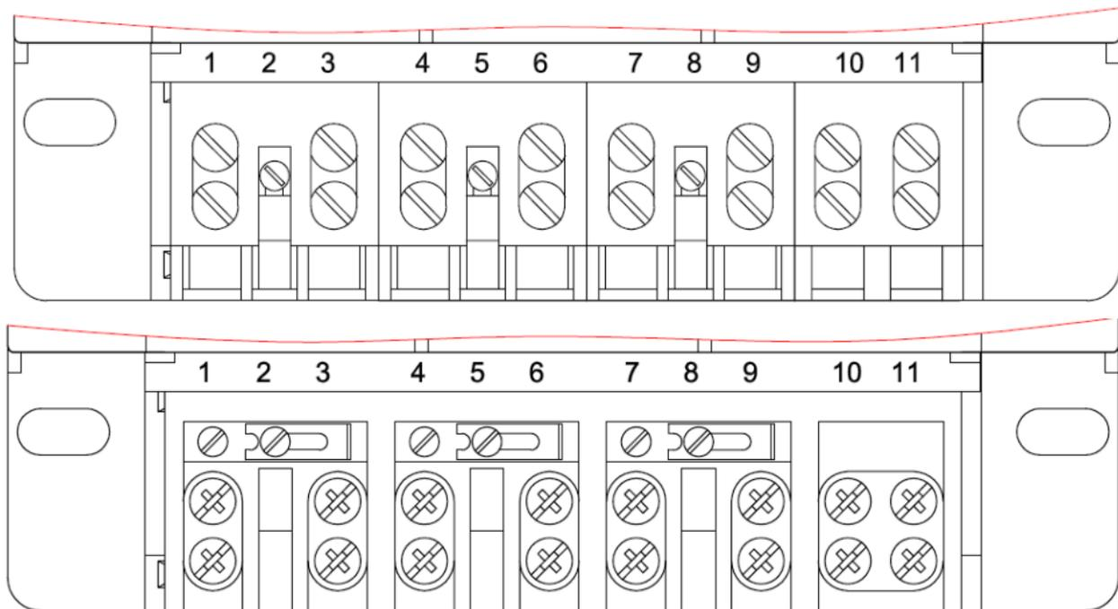
д) - обозначение контактов зажимов счетчика CE 303 S31 74X
