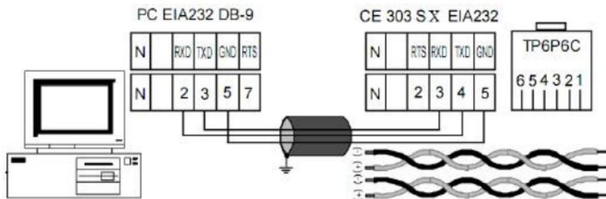
Примечание – Вилка TP6P6C – используется в счетчике с интерфейсами EIA232 и EIA485.
