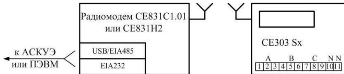
Рисунок 3.7 - Схема подключения счетчика
