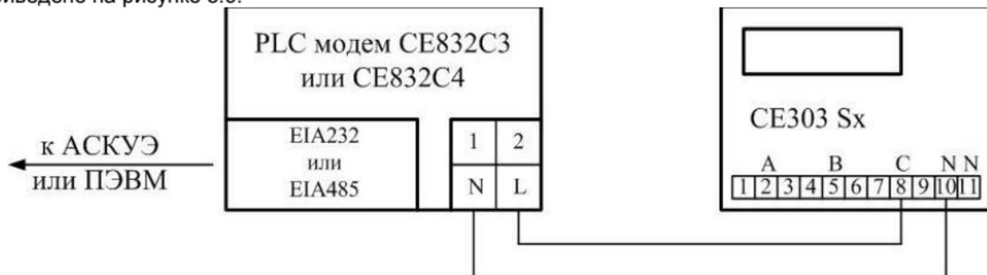
Рисунок 3.9 – Схема подключения счетчика
