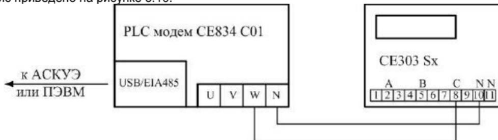
Рисунок 3.10 – Схема подключения счетчика
