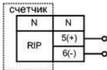
$U_{пит}=9-24$  В,  $I_{пит}=800-300$  мА (в зависимости от  $U_{пит}$ ) - для исполнений счетчика со встроенным GSM модулем.
