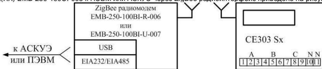
Рисунок 3.8 - Схема подключения счетчика
