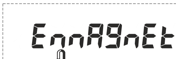
Рисунок 2.14 Информация, выводимая на ЖКИ при ВЧ электромагнитном воздействии на счетчик
