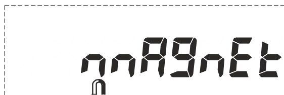
Рисунок 2.12 Информация, выводимая на ЖКИ при магнитном воздействии на счетчик
